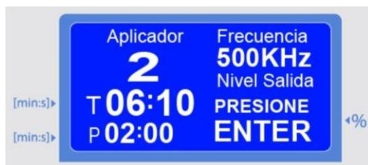
El nivel de salida inicial será de 0%. Para ajustar la intensidad se utiliza la tecla UP y DOWN, en un rango de 0 a 100% a intervalos de 10.
